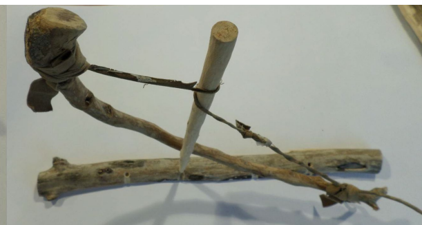
sistema a rotazione con un archetto
